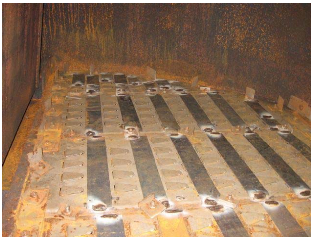
Рис. 6. Пример перекрытия клапанов тарелки
