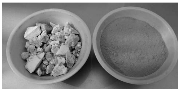
а: слева – исходная руда; справа – обожженная при 700 °С и измельченная до 140 мкм
