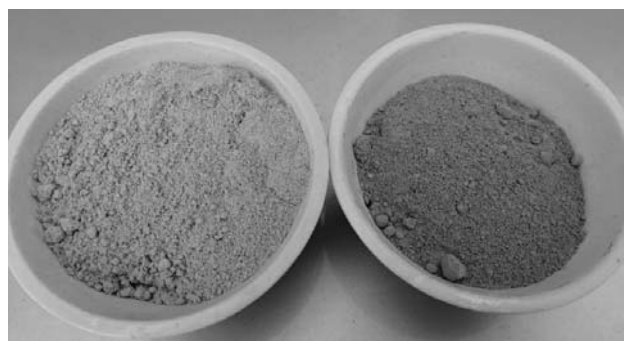
в: слева – исходная руда; справа – обожженная при 700 °С и измельченная менее 140 мкм
