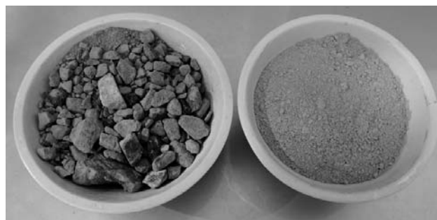
б: слева – исходная руда; справа – обожженная при 900 °С и измельченная менее 140 мкм
