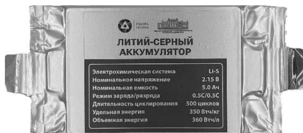
Рис. 15. Фото лабораторного прототипа литий-серного аккумулятора пакетного типа в мягком металл полимерном корпусе ( pouch cell )
