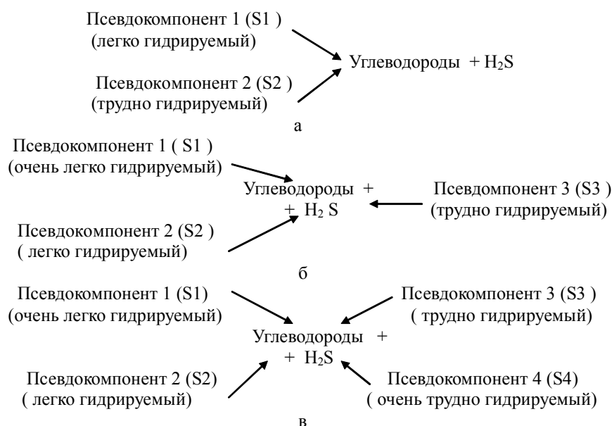
Рис. 1. Обобщенные схемы химизма процесса гидроочистки с числом псевдокомпонентов 2 (а), три (б) и четыре (в) по 22 .
