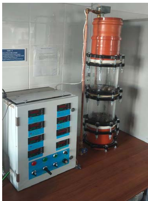
Рис. 1. Лабораторный стенд с колпачковыми тарелками
