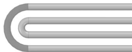
Рис. 12. Схема конструктивного выполнения узла поворота потока с применением отводов 180° с увеличенным радиусом закругления R = 3D (выделен оранжевым)
