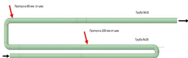
Рис. 4. Схема расположения места разгерметизации в 2023 г. на выходной трубе №31 и предпоследней трубе №28 152x8 потока №4 змеевика печи П-1/2 (показано красной стрелкой), направление движения среды показано черными стрелками
